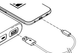
1. Schließen Sie Ihr Mobilgerät wie abgebildet mit einem USB-Ladekabel an die Powerbank an.
