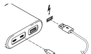
1. Schließen Sie die Powerbank wie abgebildet mit dem beiliegenden USB-C/USB-A-Ladekabel oder mit einem Micro-USB/USB-A-Ladekabel an eine der beiden Eingangsbuchsen der Powerbank und einen USB-Netzadapter (nicht im Lieferumfang) an.
